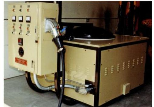
Esta opción de "conexión" transportable esta disponible en todos los modelos **THERMTRONIX®** de acero rolado ó marco de acero.
